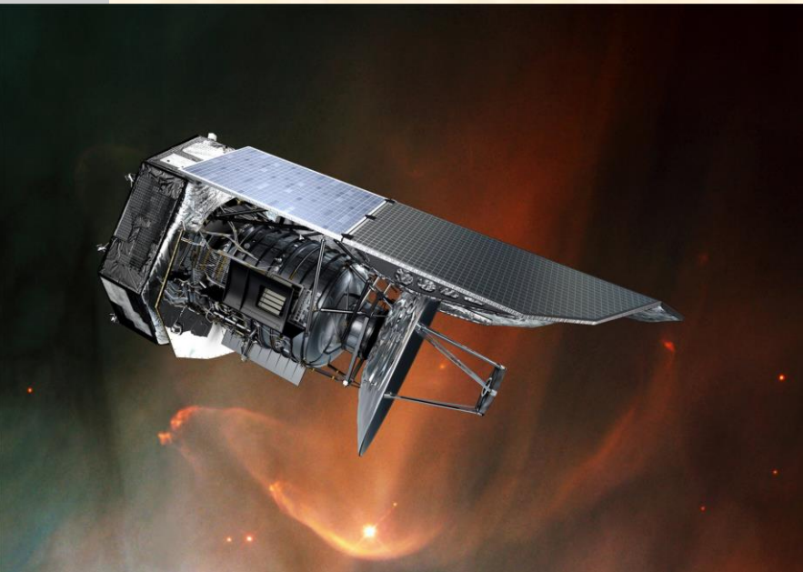
Herschel space telescope, 2009-2013; sub millimeter waves : 55 à 672 \mu\text{m} (Far infrared)
